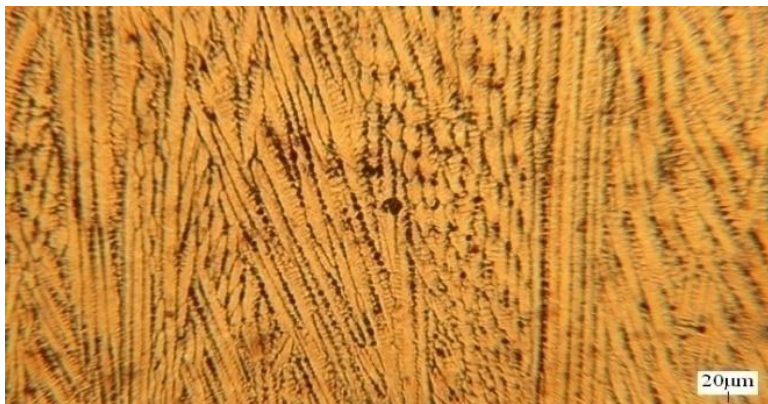
自由成形（柱状晶 枝晶间距 28\mu ）
