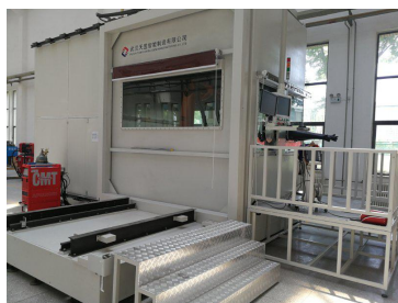
TY-2H800 冷弧增材制造设备
